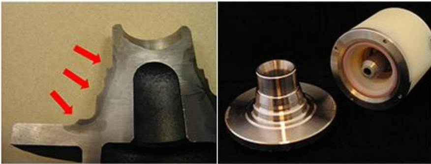
Wheel bearing 열처리검사 (다중 센서)
