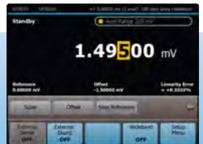
OFFSET 및 SCALE 키로 0 오프셋과 확장 오류를 간편하게 보정하고 모든 확장 수준에서 선형성 오류를 직접 표시할 수 있습니다.
