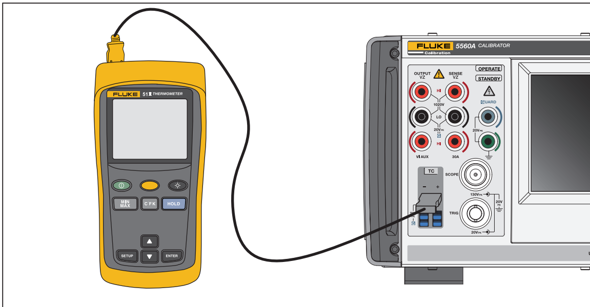
그림 14.50 시리즈 온도계 테스트를 위한 케이블 연결
